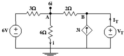
۱۹- گزینه «۱» باید مدار معادل تونن را از دو سر a و b پیدا کنیم. برای این کار منبع ولتاژ تست  $V_T$  را در دو سر a و b قرار داده و رابطه  $V_T$  با  $I_T$  که جریان عبوری از منبع می‌باشد را به دست می‌آوریم:
