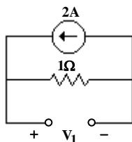
۲۱- گزینه «۲» در گام اول ولتاژ  $V_1$  را در لحظه‌ی صفر محاسبه می‌کنیم. در  $t = 0$ ،  $i_S = 2$  آمپر بوده و کلید در وضعیت OA قرار دارد. با فرض آن‌که مدار در حالت دائمی باشد، خازن همچون مدار باز عمل کرده و داریم:
