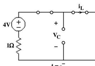
۲۲- گزینه «۴» ابتدا با تحلیل مدار در  $t = 0^-$ ، شرایط اولیه مدار را به دست می‌آوریم. در این لحظه خازن مدار باز و سلف اتصال کوتاه است:
