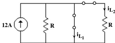
۱۸- گزینه «۳» ابتدا مدار را در حالتی که کلید بسته است، تحلیل کرده و جریان سلفها را محاسبه می‌کنیم. در این وضعیت با فرض آن که مدار در حالت دائمی باشد، سلف‌ها همچون اتصال کوتاه عمل می‌کنند. بنابراین مدار به شکل روبرو مدل می‌شود:
