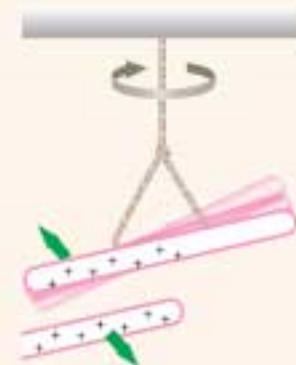
ب) وقتی دو میله شیشه‌ای را با پارچه ابریشمی مالش دهیم، همدیگر را دفع می‌کنند.
